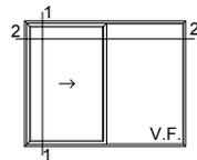
ACRISTALAMIENTO DESDE 4mm HASTA 24mm DE ESPESOR. DISEÑO DE 3 CÁMARAS DE AISLACIÓN EN MARCO.
